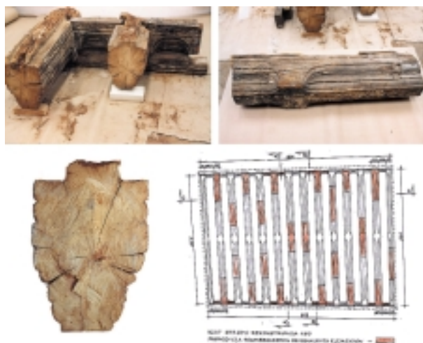
Ryc. 3. Przemysł. Pocięty renesansowy strop
