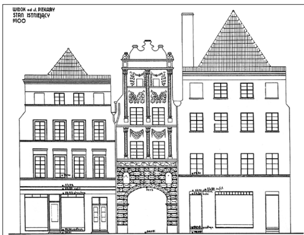
Ryc. 4. Rysunek elewacji kamienic przy ul. Piekary 35–39; oznaczenia: A – przed wybicciem bocznych przejazdów w 1936 w celu przeprowadzenia linii tramwajowej (rys. ze zbiorów Archiwum Państwowego w Toruniu, Akta miasta Torunia D, sygn. 2702, k. 20), B – fotografia stanu współczesnego, po usunięciu linii tramwajowej w 1971; fot. M. Prarat 2020.
