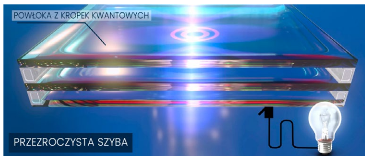
Ryc. 10. Dwukomorowy, całkowicie przezierny zestaw szybowy produkujący prąd
