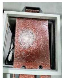
Ryc. 3. Fotowoltaiczna dachówka ceramiczna po testach uderzeniowych
