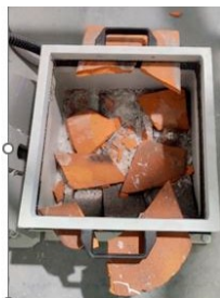
Ryc. 2. Klasyczna dachówka ceramiczna po testach uderzeniowych
