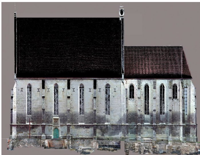
Ryc. 4. Wiślica, rzut ortogonalny południowej elewacji kolegiaty, wraz z jej odcinkowo dokumentowanymi fundamentami, 2019-2021; wyk. A. Gołębniak, I. Żyła-Sutkowska i Anna H=Gołębniak
